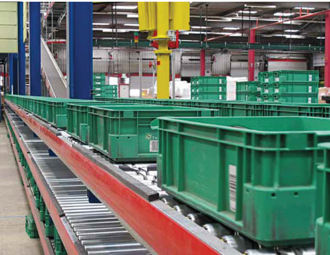
▲ Via een 6,5 kilometer lang systeem van lopende banden, rollerbanen en paternosters worden de groene bakken op de juiste plek gebracht
